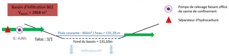
Figure 17 : Schéma de principe du bassin d'infiltration des eaux de voirie B02
