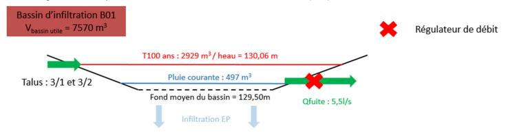
Figure 16 : Schéma de principe du bassin d'infiltration/rétention des eaux de toiture B01
